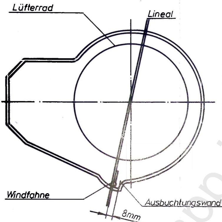
Lineal über Drehpunkt des Lüfterrades mit Abstand 8 mm von der Ausbuchtungswand anlegen. Windfahne zum Lineal bewegen. Die Fläche der Windfahne muss mit dem Lineal fluchten. Abweichende Stellung durch Nachbiegen der Windfahne ausgleichen!
